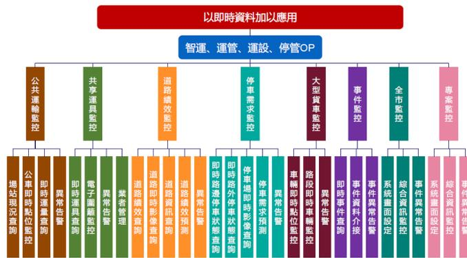
圖 6 交通即時監控系統功能架構
