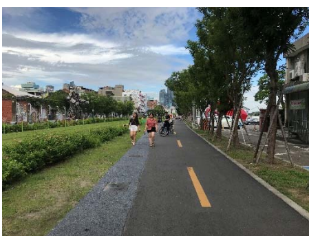
⑧ 駁二藝術特區路段路幅大，但未劃設相關自行車圖樣及標示牌，易造成民眾困惑，建議新增標示引導自行車使用者。
