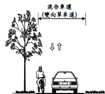
圖 2-11 自行車與汽機車共用 混合車道 ( Type11 )
