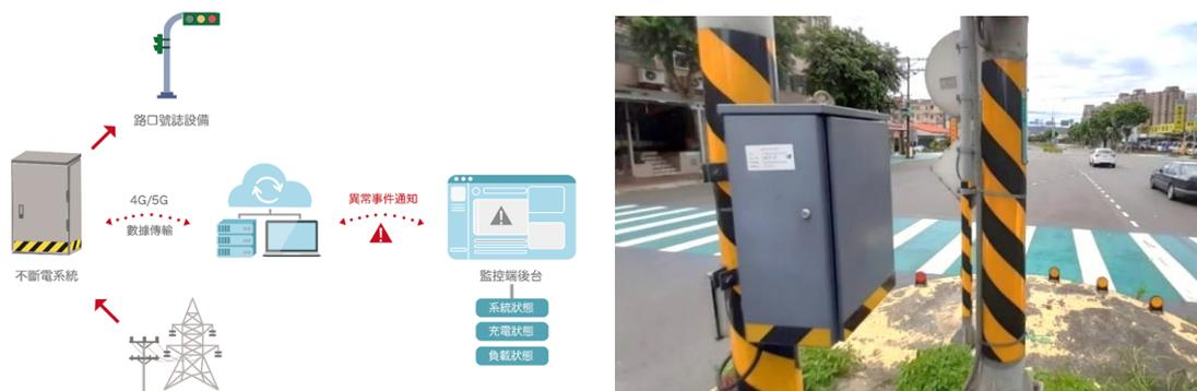
圖2 交通號誌緊急供電及遠端監控系統運作模式及示意圖
