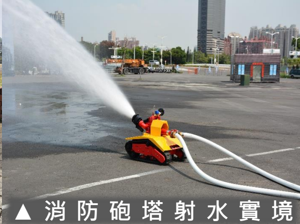
▲ 遙控無人消防砲塔
