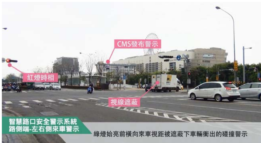
圖 54 智慧路口防碰撞系統
