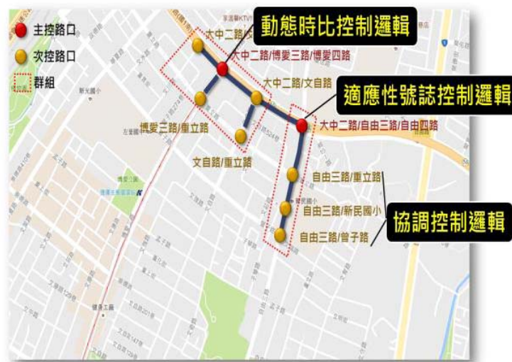
圖 47 國 10 下匝道智慧化號控系統
