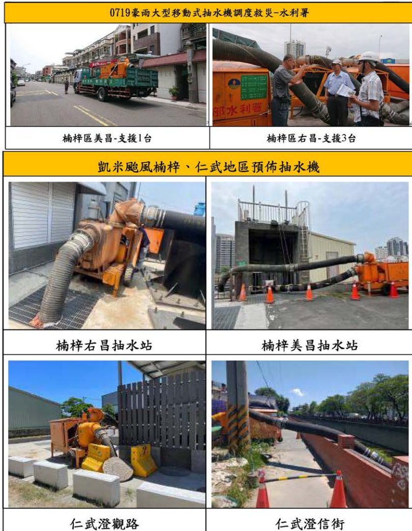
圖四 楠梓仁武地區大型移動式抽水機支援淹水救災情形
