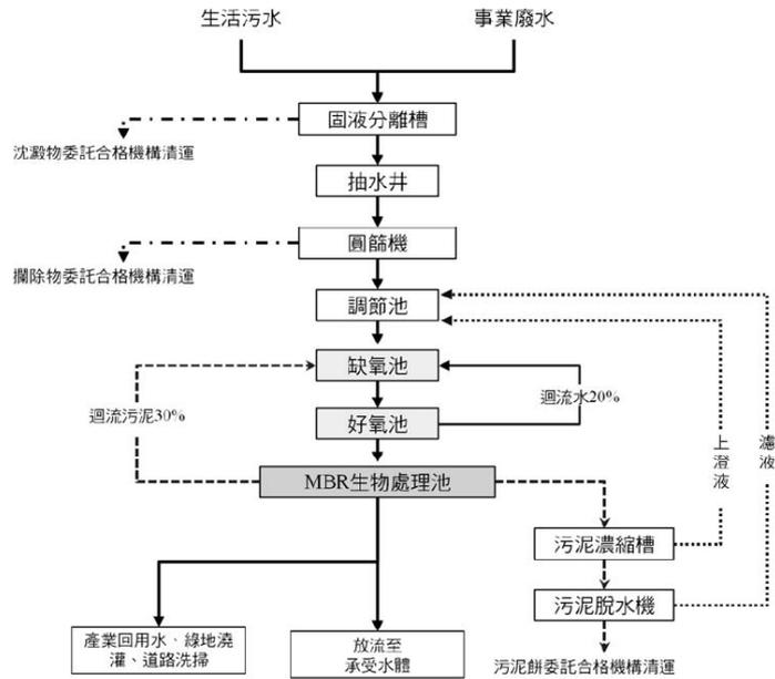
圖 5.9-2 廢(污)水處理流程規劃示意圖
