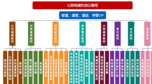
圖 6 交通即時監控系統功能架構
