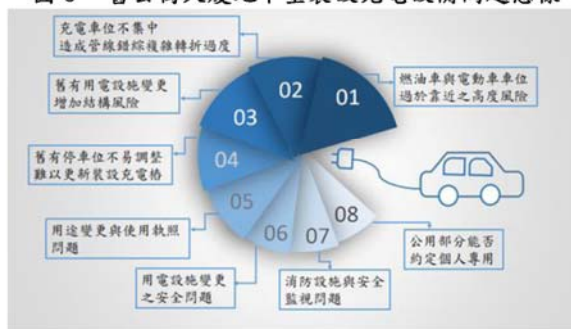
圖3 舊公寓大廈地下室裝設充電設備問題態樣
