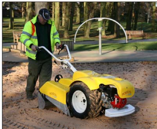
國外採用手推自動翻沙機具進行沙坑維護工作·能清除沙池內的異物·亦能將底部的沙翻動·達到曝曬陽光殺菌的效果。(圖片擷取自網路)
