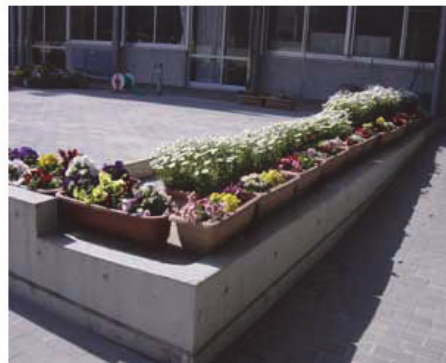
■写真 4-2-5 教室の外部出入口付近の植栽の例 ・侵入者が接近しにくいよう、外部に面した教室の出入口の前に植栽を配置している。
