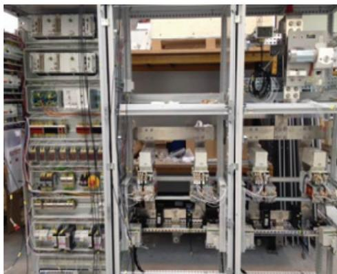
供電系統：快速充電電源供應器製造
