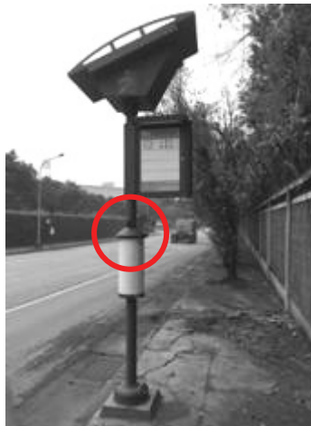
電梯式公車太陽能智慧型站牌按鈕安裝位置
