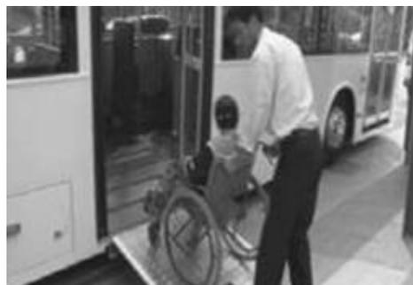
低地板公車中車門設有手動式渡板，方便輪椅/推車上下公車
