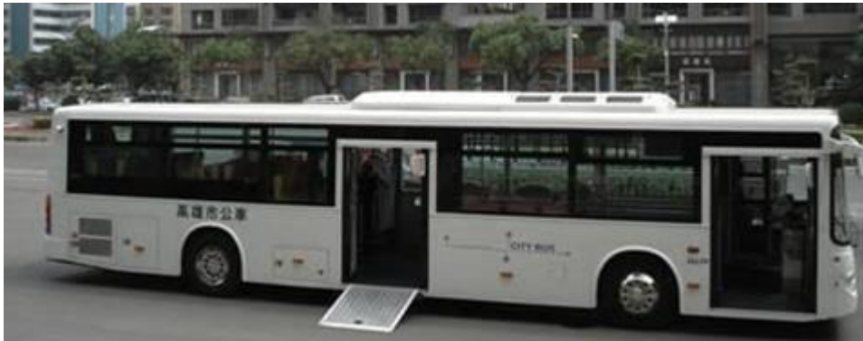
低地板公車車門設有手動式渡板，方便輪椅/推車上下車
