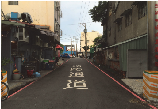
鼓山區濱海一路 57 巷消防禁停標線
